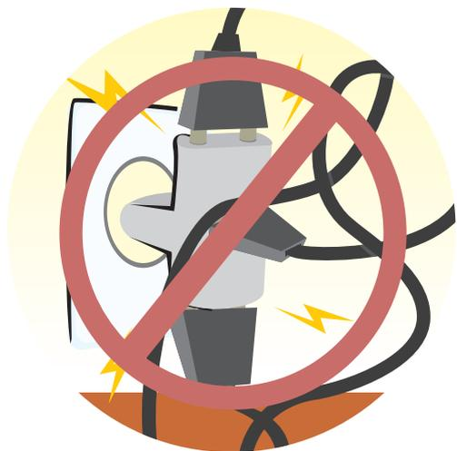
Antes de iniciar qualquer trabalho em máquinas ou instalações elétricas, ter sempre o cuidado de desligar a fonte de energia (disjuntor). Choques elétricos podem resultar em lesões graves ou mortes.
